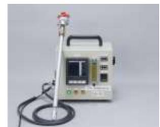
図1 起電特性 図2 炉内測定用水素センサ
